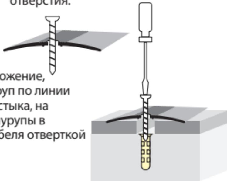
3. Вернуть стык в исходное положение, равномерно распределить шуруп по линии стыка; опустить порог к линии стыка, на небольшую глубину вставить шурупы в дюбели; вкрутить шурупы в дюбели отверткой или шуруповертом.
