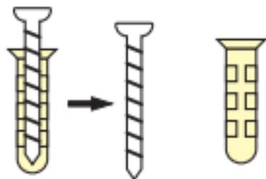
2. Уложить напольные покрытия; по линии стыка равномерно распределить и просверлить отверстия; с помощью молотка вставить дюбели в просверленные отверстия.
